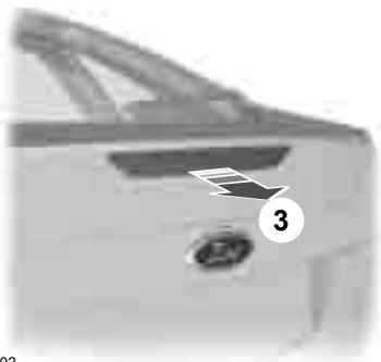
3. Снимите модуль лампы.
