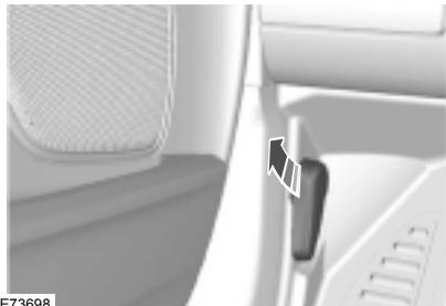
Слегка приподнимите капот и передвиньте фиксатор в направлении левой стороны автомобиля.
