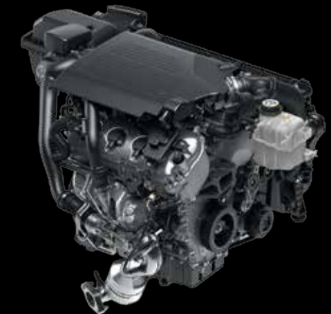
Двигатель EcoBoost 3,5 л 345 л.с. GTDi
