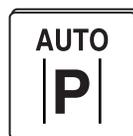
парковки справа/слева) и соответствующее изображение. Чтобы обозначить, с какой стороны улицы должен вестись поиск, используйте указатель поворота для выбора, с какой стороны автомобиля система АРА будет производить парковку. (Если указатель поворота не был включен, то система автоматически производит поиск ко стороны пассажира).
