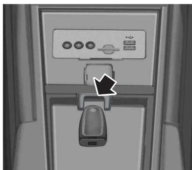
После этого произведите запуск автомобиля обычным способом с помощью кнопки START/STOP и педали тормоза. Автомобиль будет реагировать на ваши действия как обычно, пока IA-ключ находится в резервном гнезде. После запуска IA-ключ можно по желанию извлечь из резервного гнезда.
