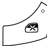
Нажмите на кнопку для блокировки всех переключателей стеклоподъемников (за исключением переключателей водителя и пассажира на переднем сиденье). Для отключения этой функции снова нажмите на кнопку.
