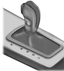
**⚠ ПРЕДОСТЕРЕЖЕНИЕ:** Всегда полностью включайте стояночный тормоз и следите за тем, чтобы рычаг выбора передач был надежно зафиксирован в положении P (Парковка). Всегда поворачивайте ключ в замке зажигания в положение блокировки и извлекайте его, если покидаете автомобиль.
