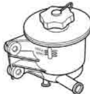
5. Если уровень рабочей жидкости низкий, доливайте ее небольшими порциями, непрерывно проверяя уровень, пока он не достигнет диапазона между отметками "MIN" и "MAX". Обязательно установите крышку на бачок.
