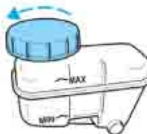
**Рекомендуется использование жидкости DOT 3. При отсутствии жидкости DOT 3 возможно использование жидкости DOT 4.**
