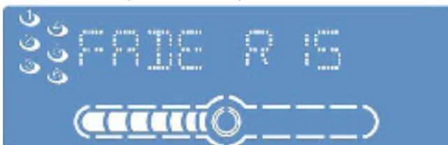
Поверните регулятор [PWR/VOL] по часовой стрелке, чтобы усилить передний динамик ( F : 0 ~ F15)
