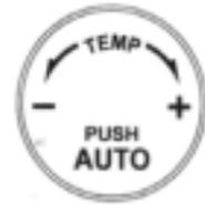
2. Выберите желаемую температуру с помощью регулятора температуры. Система кондиционирования воздуха автоматически задает температуру и расход поступающего через дефлекторы воздуха, режим рециркуляции или подачи наружного воздуха.
