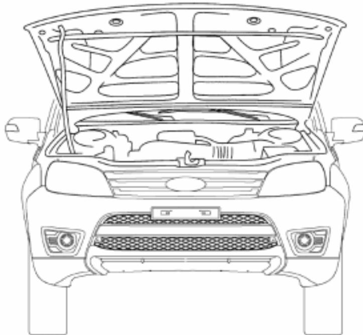
2. Встав лицом к капоту, поднимите вспомогательный фиксирующий рычаг, расположенный по центру, между капотом и решеткой радиатора.
