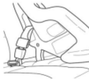
Компания Ford рекомендует использовать детские сиденья, оснащенные верхним фиксирующим ремнем. Установите безопасное детское сиденье на посадочное место автомобиля, оснащенное креплением для фиксирующего захвата. Дополнительная информация о верхних фиксирующих ремнях дана в разделе *"Закрепление детских сидений, оснащенных фиксирующими ремнями"*.
