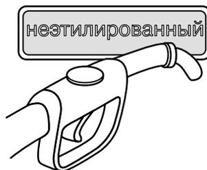
Заливная горловина топливного бака автомобилей с бензиновыми двигателями имеет уменьшенный диаметр, совместимый только с заправочными пистолетами для неэтилированного бензина.
