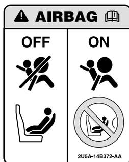
При включении зажигания (положение **II**) убедитесь в том, что загорелся сигнализатор отключения подушки безопасности.
